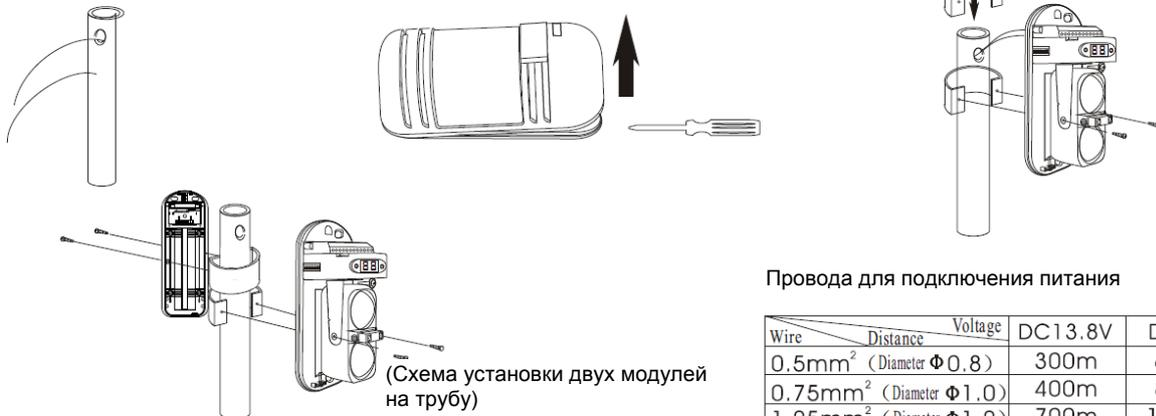
Установите влагозащитную прокладку в отверстие винта.
