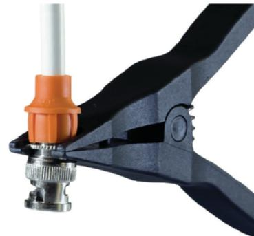
Вставьте паз разъема между закрытыми губками инструмента и надавите на ручки для разделения разъема. После разделения разъема его можно будет снять с кабеля.
